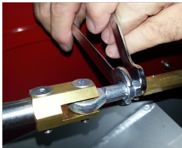
Fig. 31 для регулировки ослабить контргайку
