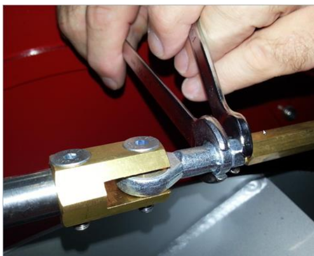
Fig. 32 после регулировки необходимо зажать
