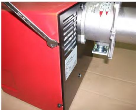
1) Снять кожух, ослабив 4 винта;
