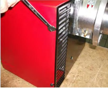
1) Снять кожух, ослабив 4 винта;
