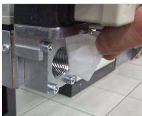
8) Снять заглушку из Труба ГАЗОВОЙ рампы;
