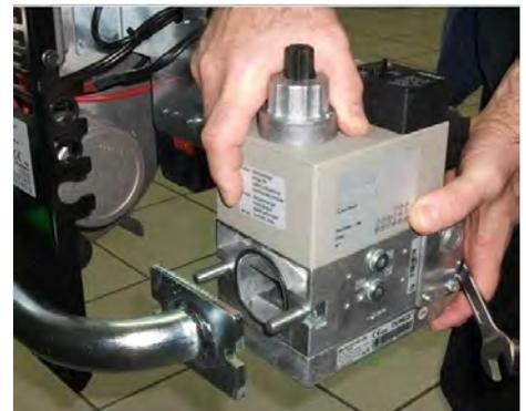
9) установить электроклапан на Труба ГАЗОВОЙ рампы;
