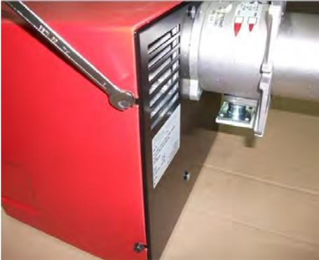
1) Снять кожух, ослабив 4 винта;
