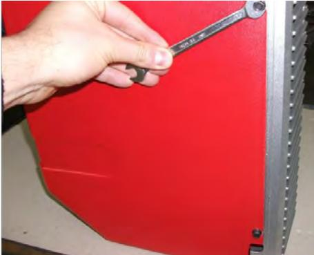
1) Снять кожух, ослабив 4 винта;
